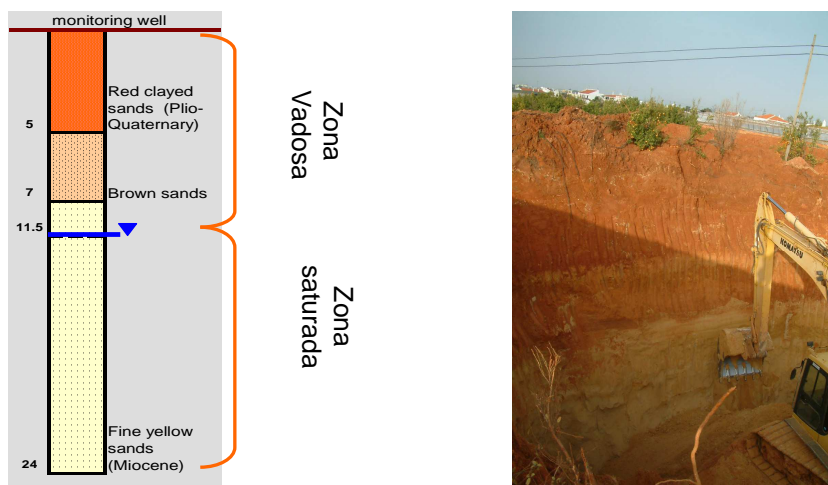
Fig. 25 – Perfil do material geológico no Areal Gordo (Algarve) no lado esquerdo e imagem real onde é possível ver-se os três materiais identificados.
