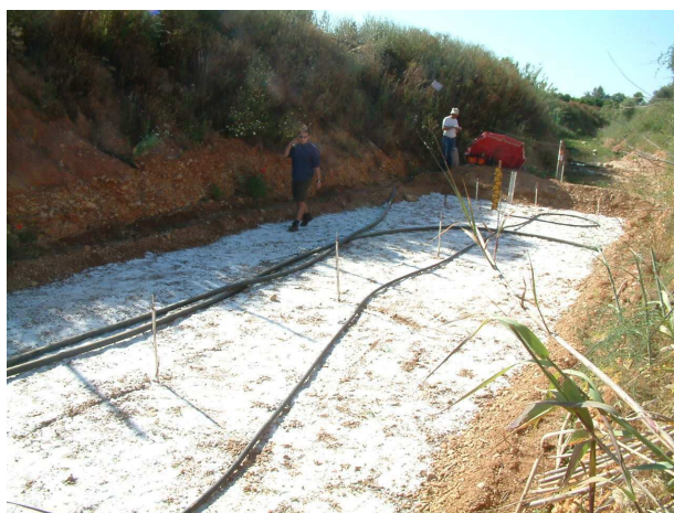
Fig. 33 – Imagem do ensaio com traçador salino realizado numa bacia no leito do Rio Seco, Algarve. Ensaio desenvolvido no âmbito do projecto GABARDINE.
