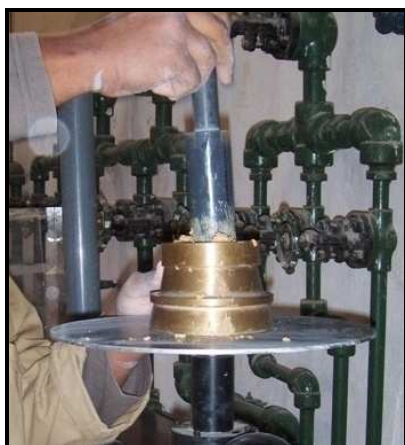
Figura 4.11 – Compactação no ensaio de espalhamento
