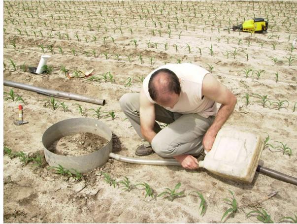
Fig. 11 - Anel de escorrência para amostragem de água superficial no Monte da Mancoca
