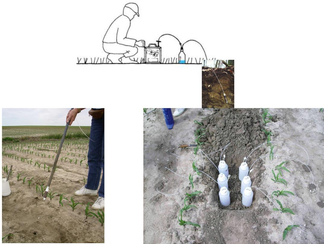
Fig. 12 - Instalação das cápsulas de Teflon® no Monte da Mancoca
