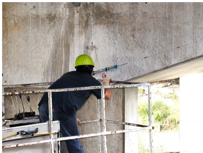
Figure 3 - Mesure des déformations par distancemétrie à fil Invar.
