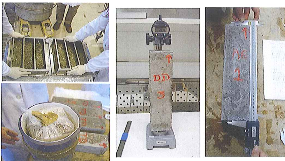
Figura 3 – Preparação e ensaio em prismas de betão segundo as normas AAR-3 e AAR-4.
