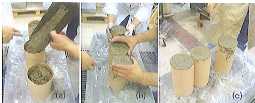
Figura 2 – Preparação dos provetes: a) enchimento dos moldes cilíndricos; b) vibração final do betão; c) aspecto do betão depois de vibrado, segundo o método de LPC nº 59.
