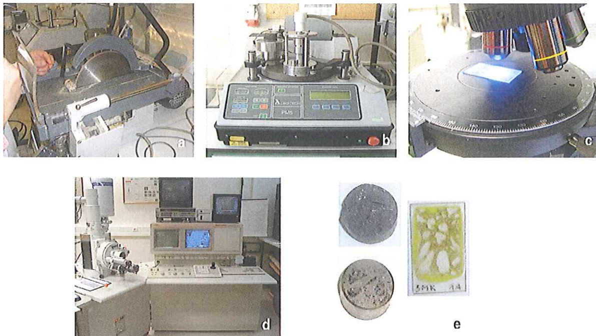
Figura 5 – Etapas da caracterização microestrutural: a) corte de amostras; b) polimento de lâminas delgadas; c) observação ao microscópio óptico; d) microscópio electrónico; e) amostras de superfície de fractura, superfície polida e lâmina delgada.
