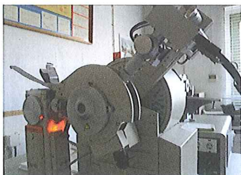
Figura 6 – Difractómetro de raios X PHILIPS X'Pert utilizado na determinação da composição mineralógica dos betões.
