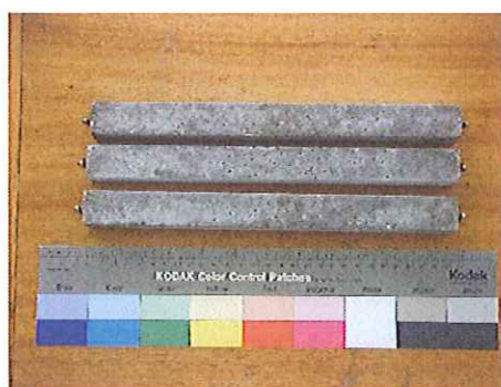
Figura 1 – Provetes do ensaio em barra de argamassa segundo a norma ASTM C 1260.
