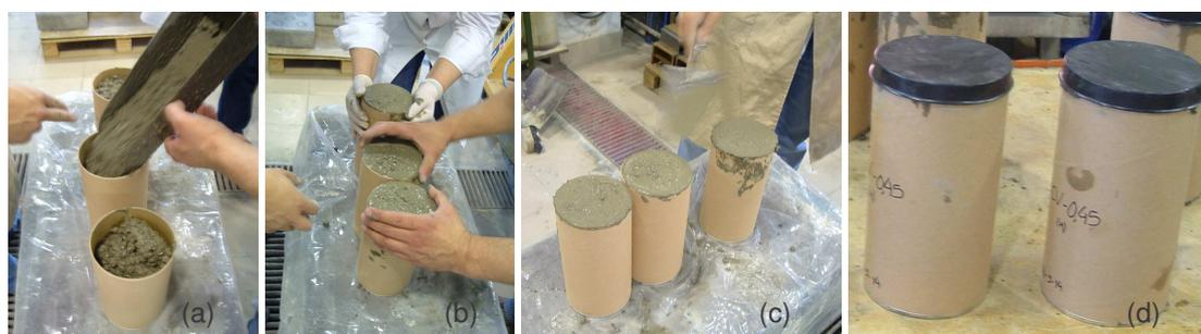
Figura 24 – Preparação dos provetes: a) enchimento dos moldes cilíndricos; b) vibração final do betão; c) aspecto do betão depois de vibrado; d) betão devidamente acondicionado nos moldes, pronto para iniciar o ciclo térmico.
