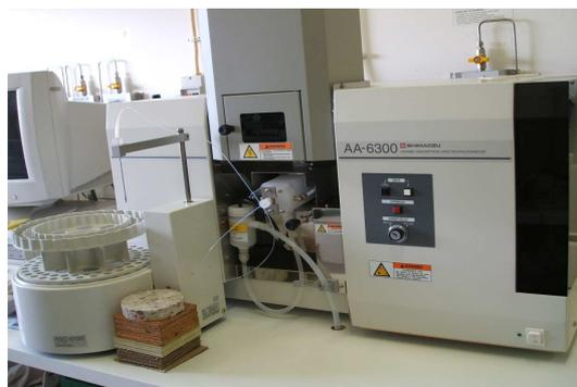
Figura 30 – Espectrofotómetro de Absorção Atómica Shimadzu AA-6300 utilizado para a determinação do teor de álcalis.
