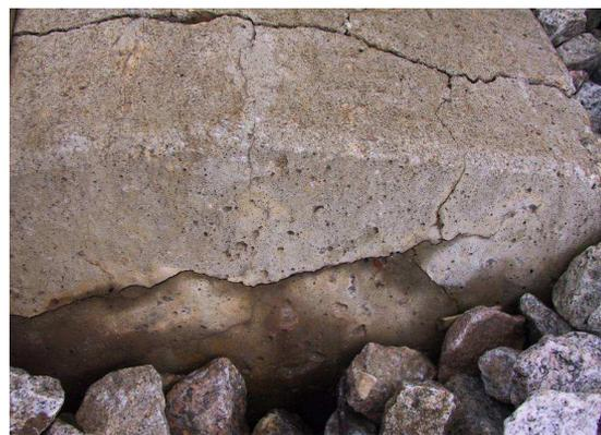
Figura 9 – Fissuração numa peça de betão que sofreu tratamento térmico.
