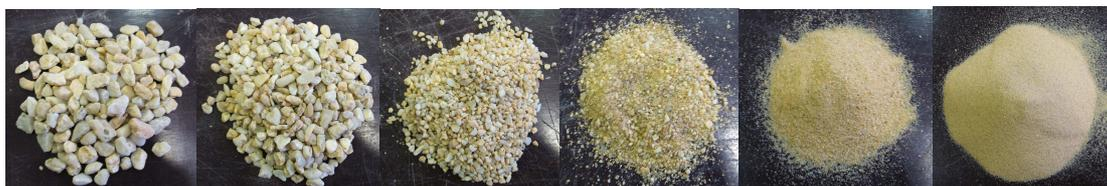
a) 8-12,5 mm    b) 4-8 mm    c) 2-4 mm    d) 1-4 mm    e) 0,315-1 mm    f) 0-0,315 mm
