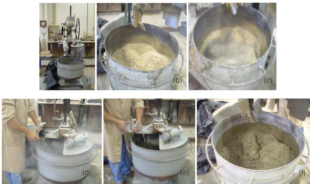
Figura 21 – Processo de amassadura do betão: a) betoneira; b) adição dos agregados; c) do cimento (+ adições); d) da água; e) da solução de NaOH; f) mistura de todos os componentes.
