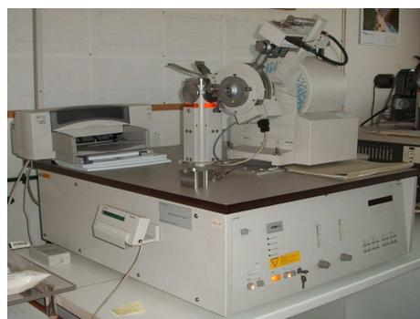
Figura 32 – Difratómetro de raios X PHILIPS X'Pert utilizado na determinação da composição mineralógica dos betões.
