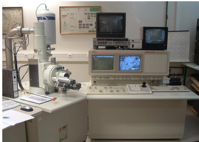
Figura 18 – Microscópio Electrónico de Varrimento JEOL JSM-6400 e Sistema EDS Oxford INCA.
