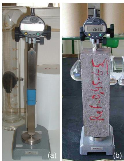
Figura 15 – Ensaio de expansão: a) comparador vertical utilizado; b) pormenor da medida da expansão num provete prismático.
