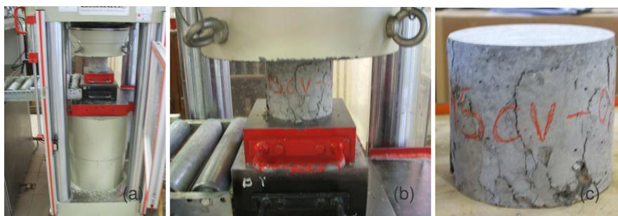
Figura 28 – Ensaio de resistência à compressão: a) prensa; b) provete sujeito à compressão na prensa durante o ensaio; c) aspecto do provete depois do ensaio.
