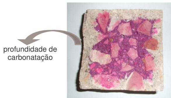
Figura 83 – Amostra de betão sujeita ao teste de carbonatação.
