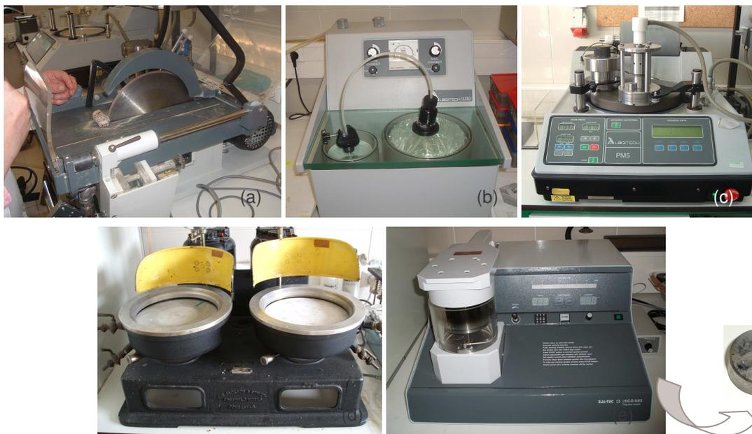
Figura 89 – Sequência de operações efectuadas para a preparação de uma superfície polida: (a) corte da superfície plana; (b) impregnação da amostra; (c) polimento com óxido de alumínio; (d) polimento com pasta de diamante de 6 e 3  $\mu\text{m}$ ; (e) metalização com ouro-paládio.
