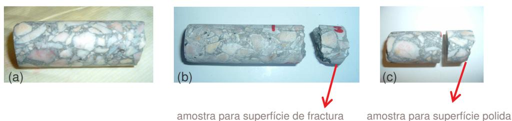
Figura 87 – a) Pormenor de uma carote extraída de um dos provetes de betão; com indicação dos provetes de superfície b) de fractura e c) polida, retirados da carote.
