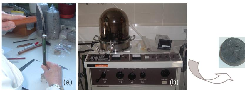
Figura 88 – Sequência de operações efectuadas para a preparação de uma superfície de fractura: (a) fracturação da amostra; (b) metalização com carbono.
