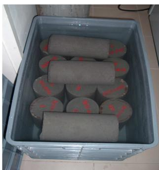
Figura 26 – Imersão dos provetes em contentores plásticos.
