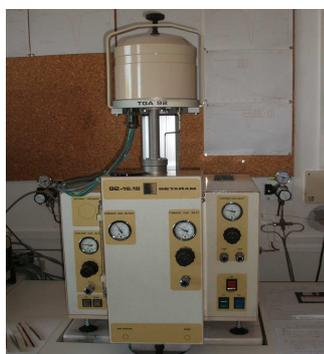
Figura 31 – Sistema de análise térmica SETARAM TGA92 utilizado para a determinação do teor de  $\text{Ca(OH)}_2$ .
