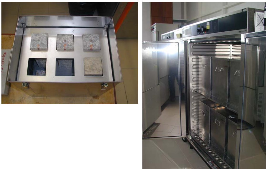
Figura 6. Ensaio RILEM AAR-3: Contentor com os prismas de betão e colocação em estufa a 38 \pm 2^\circ \text{C} [1].
