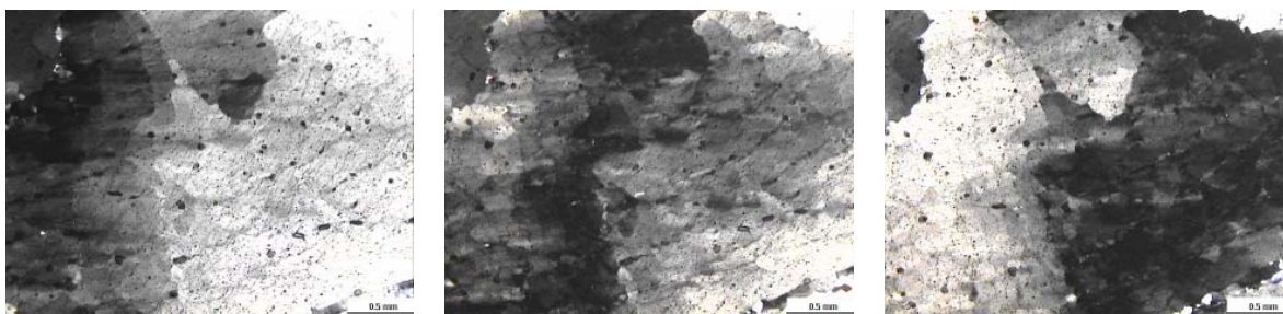
Figura 1. Quartzo exibindo extinção ondulante, observado em luz polarizada (NX). As imagens correspondem a diferentes posições de rotação da platina do microscópio petrográfico.
