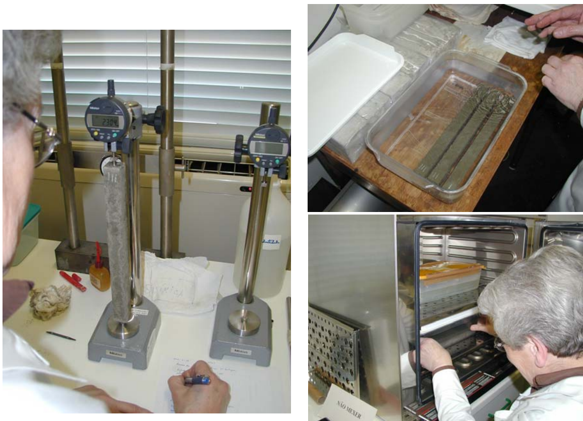
Figura 5. Ensaio ASTM C 1260: Leitura do comprimento dos provetes, imersão em água e colocação em estufa a 80 \pm 2^\circ \text{C} [1].
