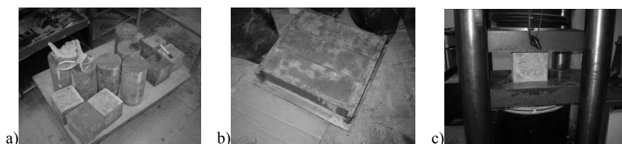
Figura 6 - Ensaio de caracterização do BO: a) provetes para ensaio de compressão e tracção; b) provetes para ensaio de observação das RAS em prisma de betão; b) exemplo do ensaio de compressão
