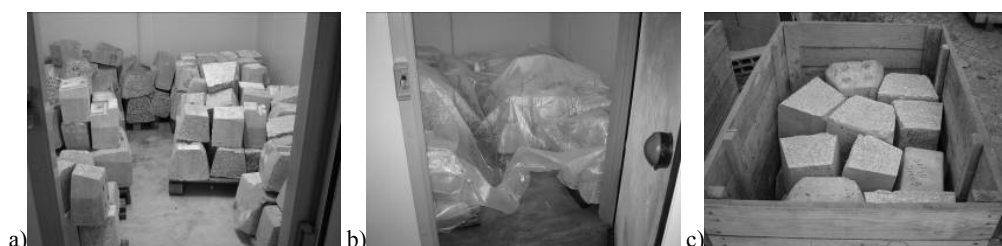
Figura 7 - a) b) Aspecto da câmara climática com os blocos de betão, protegidos por um plástico para minimizar a lixiviação; c) aspecto do armazenamento dos blocos ao ar livre, simulando uma exposição natural
