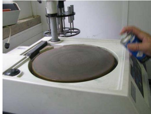
Fig. 6 - Máquina de polir com abrasivo de diamante.
