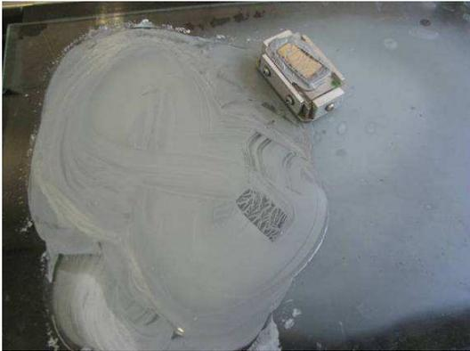
Fig. 5 - Desbaste no abrasivo de 9µm.
