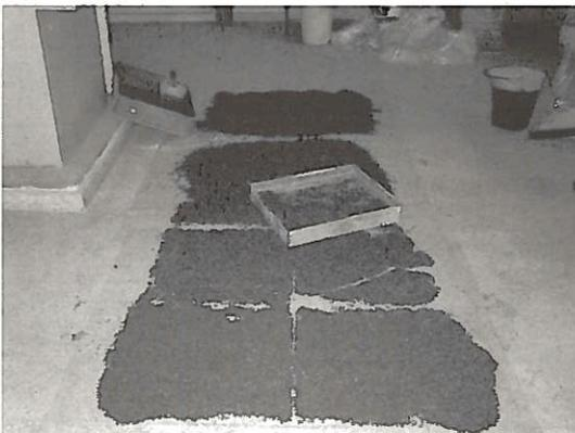
Fig. 4 - Agregados cerâmicos colocados sobre plásticos para secarem
