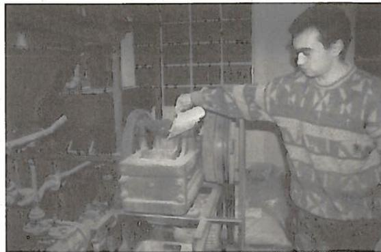
Fig. 8 - Trituradora de menores dimensões usada apenas no 3º ciclo de reciclagem
