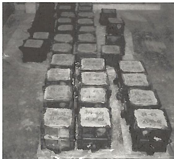
Fig. 6 - Aspecto dos cubos de ensaio após a sua marcação e imediatamente antes da sua descofragem e colocação na câmara de cura
