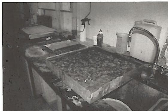
Fig. 2 - Aspecto dos agregados reciclados imersos em água para determinação da sua absorção
