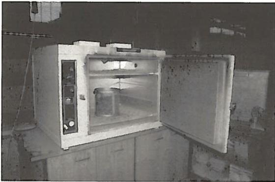
Fig. 4 - Estufa para secagem dos agregados
