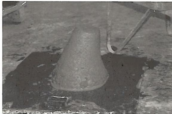
Fig. 5 - Ensaio do cone de Abrams feito ao betão com agregados grossos reciclados
