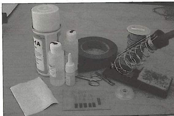
Fig. 2 - Material para preparação e colagem do extensómetro.
