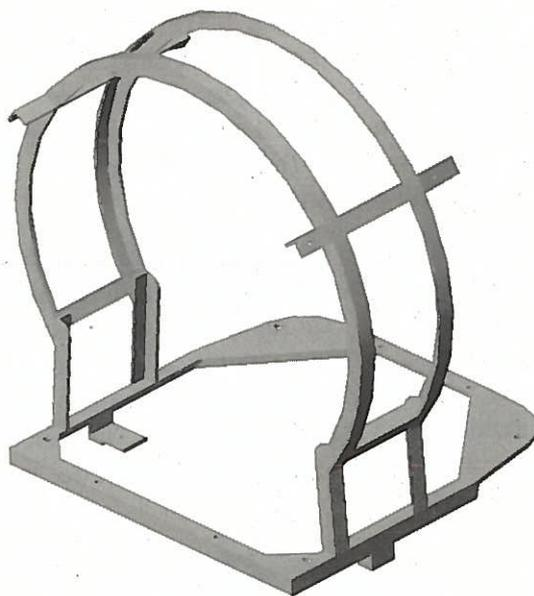
Fig. 3 – Estrutura de suporte da cuba (modelação e peça fabricada).
