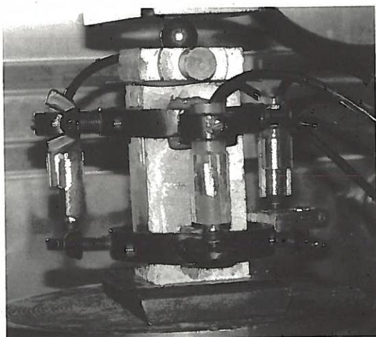
Fig 3 – Ensaio de provetes de argamassa
