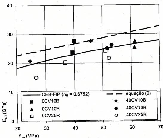
Fig 8 – Relação entre  $E_{cm}$  e  $f_{cm}$  (CEB/FIP:  $\alpha_E=0.6751$ ; equação (9))
