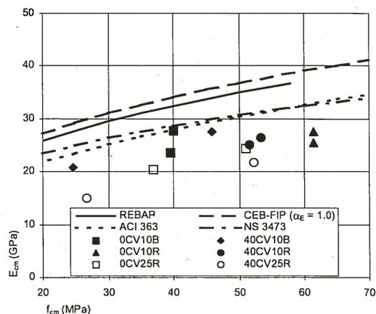
Fig 7 – Relação entre o módulo de elasticidade e a resistência à compressão média
