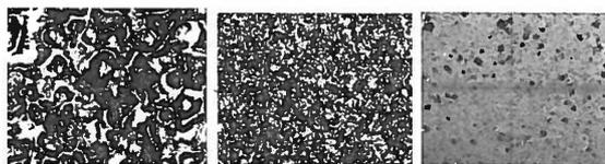
**Fig. 6-** Aspecto da superfície maquinada (m. o. 500x): a) desbaste; b) acabamento; c) polimento.
