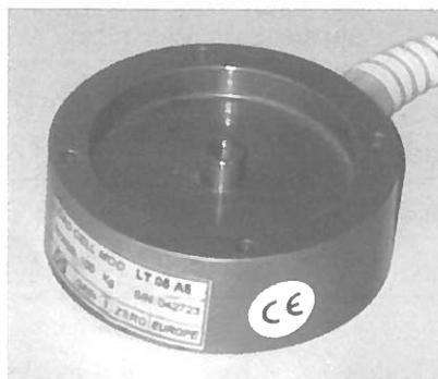
**Figura 10** - Células de carga utilizadas na balança de esforços
