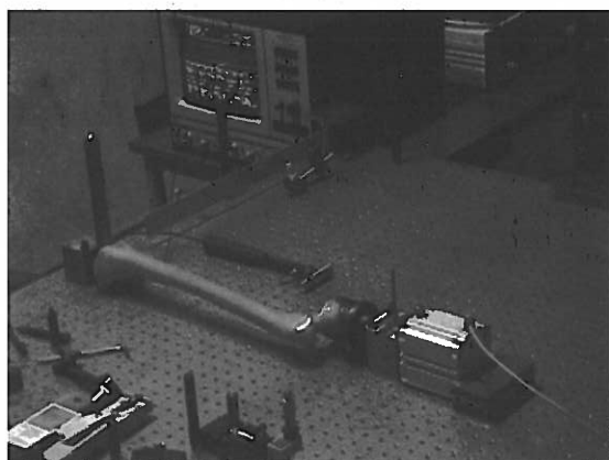
Figura 7 - Sistema experimental para análise dinâmica do modelo femoral bi-apoiado e submetido a uma carga axial.
