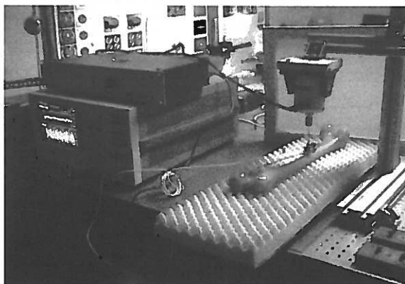
Figura 1 – Sistema experimental para análise modal do modelo femoral livre-livre.
