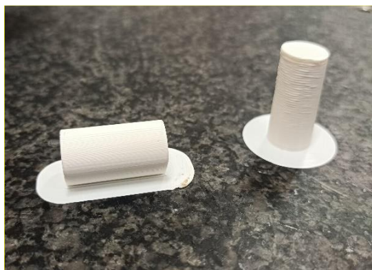
Fig. 2 | Amostras em PLA cilíndricas construídos na horizontal e na vertical
