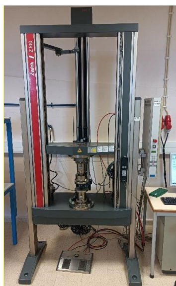
Fig. 4 | Equipamento Universal de Ensaios Mecânicos: ZWICK - Z100
