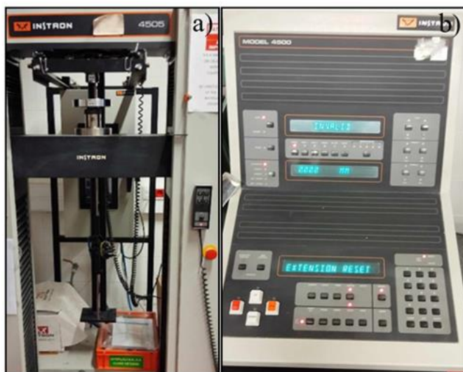
Fig. 9 | a) Equipamento de ensaios de tração uniaxial, Instron 4505. b) Controlador Instron 4000.
