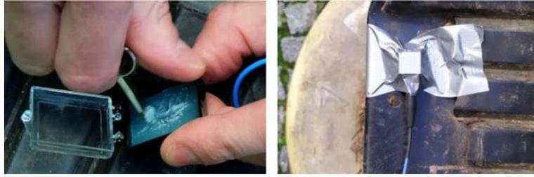
Fig.4 | Montagem do acelerómetro do pé.
