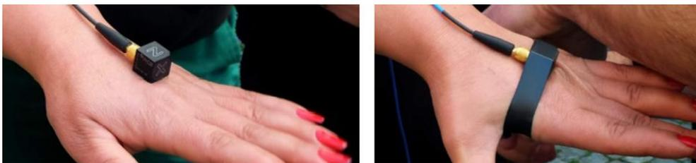
Fig. 6 | Montagem do acelerómetro na mão da operadora.
