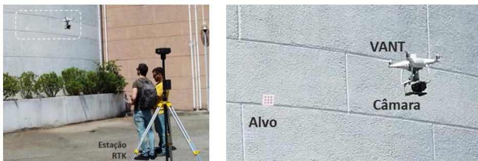
Fig. 11 | Configuração experimental do ensaio em campo
