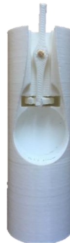
Fig. 7 - Corpo cilíndrico com a roda e seletor vertical.
