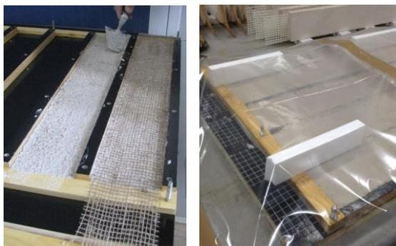
**Fig 1** - Provetes de revestimento armado: execução (esq) e cura (dta)
