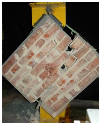
Fig 8 - Tipo de rotura do *wallete* sem reforço M1M5
