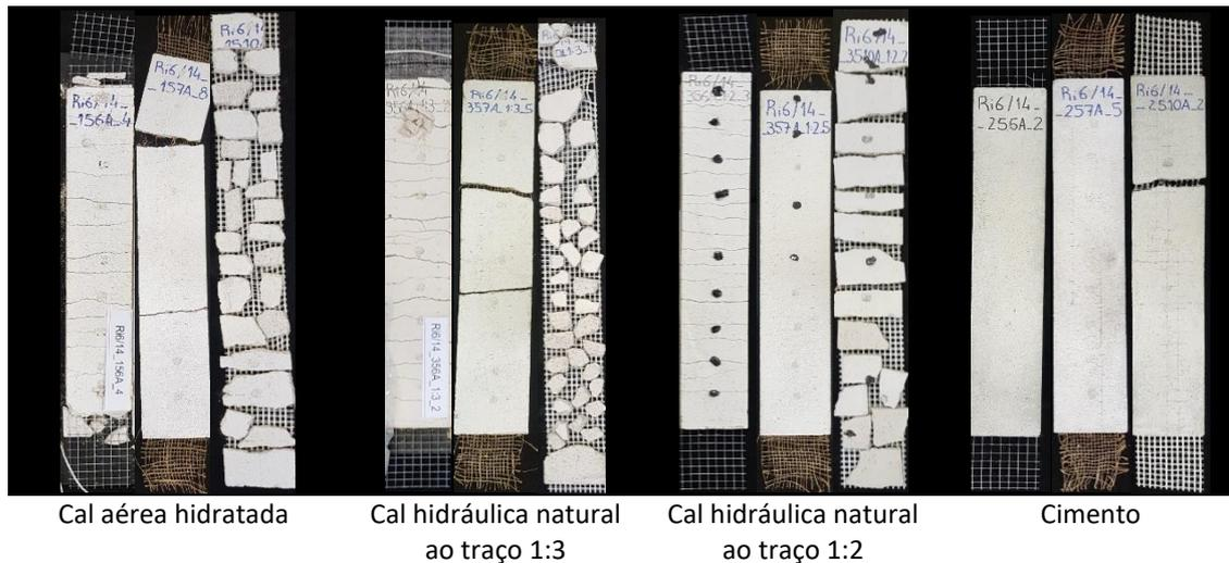
**Fig 4 -** Mecanismos de rotura de cada um dos tipos de revestimentos armados constituídos pelos vários tipos de argamassa e as redes metálica, de juta e de fibra de vidro
