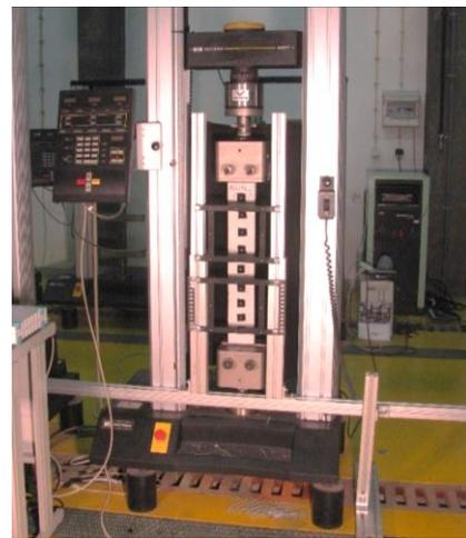
**Fig 2** - Aspeto geral da realização de um dos ensaios de tração e alongamento na rotura
