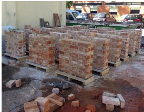
Fig 5 - Construção de *wallettes* novos de tijolo cerâmico maciço
