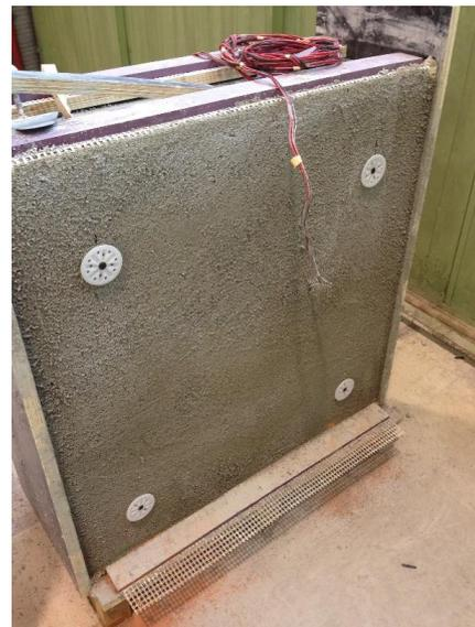
Fig 6 - Aplicação dos revestimentos armados nos *wallettes*
