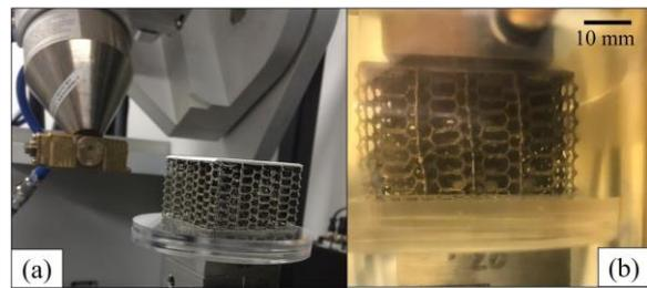
Fig 5 -  $4D \mu CT$ : (a) amostra em repouso no scanner; e (b) em compressão dentro do aparato.
