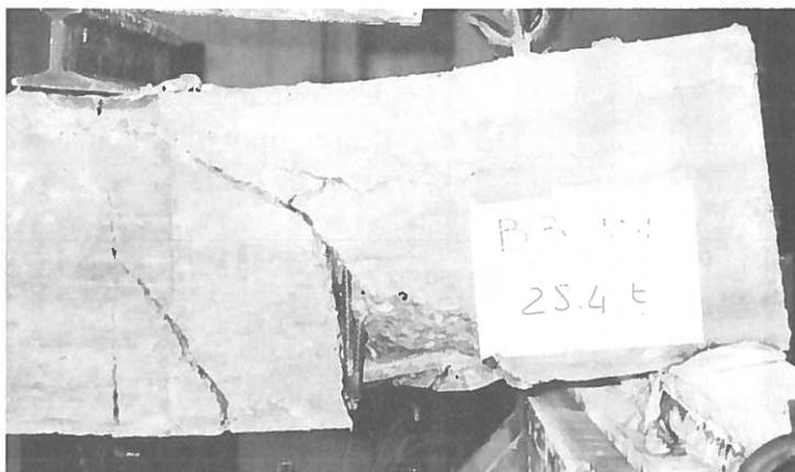
Figura 14 - Modo de colapso para a viga do tipo B3 reforçada com varões de GFRP.
