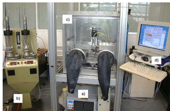
Fig. 2 - Sistema laboratorial LASER Cladding: a) LASER IPG YLR 200 AC; b) alimentador de pós PLASMA-TECHNIK AG TWIN 10C c) Câmara de luvas; d) computador pessoal (Torres et al, 2015).
