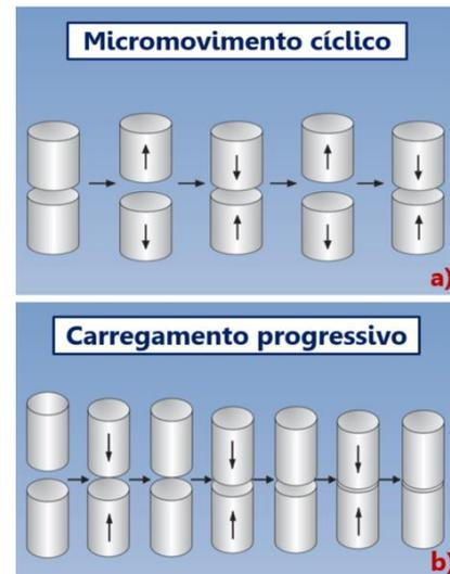
**Fig 1-** Micromovimentos aplicados na fratura: a) cíclico; b) carregamento progressivo (Goldberg A. e Scott J.).
