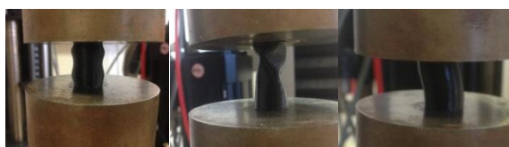
Fig 13 – Deformações observadas durante os ensaios de compressão.
