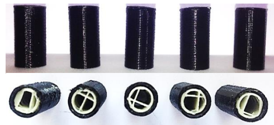
Fig 8 – Resultado obtido após fabricação e pós-processamento dos provetes 50% nylon com suporte.
