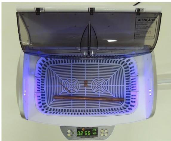
Fig. 2 – Limpeza dos componentes de um termossifão em banho ultra-sônico.
