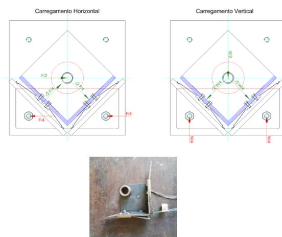
**Fig 6** - Esquema de medição das forças nos apoios do perfil de sombreamento na posição vertical da estrutura de suporte e um dos ortodinamómetros.
