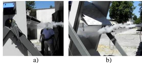
**Fig 12** - Visualização do escoamento com injeção de fumo para: a)  $\alpha=30^\circ$  e b)  $\alpha=50^\circ$ .
