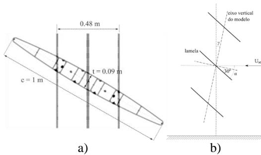
**Fig 3** - a) esquema de perfil das lamelas e do perfil vertical de suporte; b) esquema de perfil do modelo com as 3 lamelas, inclinado de um ângulo  $\gamma$  relativamente ao referencial terrestre.
