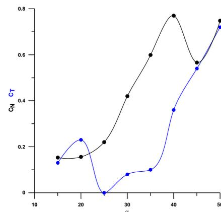
Fig 8 - Gráfico dos coeficientes de força normal e tangencial em função do ângulo de ataque, obtidos experimentalmente.
