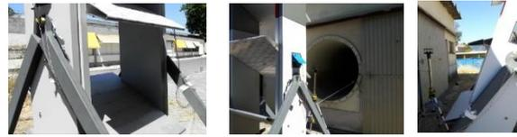
**Fig 5** - Pormenor do modelo seccional, saída do túnel de vento de jato livre do LNEC e anemómetro de ultra-sons 2D.
