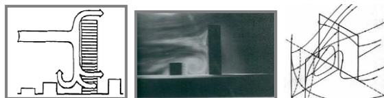
**Fig 2** - Ilustração da interação de um escoamento de camada limite com a fachada de um edifício (Cochran, 2004; Simiu e Scanlan, 1996).
