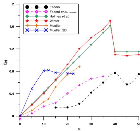
Fig 9 -  $C_N$  vs  $\alpha$  e comparação dos resultados experimentais com dados publicados na literatura
