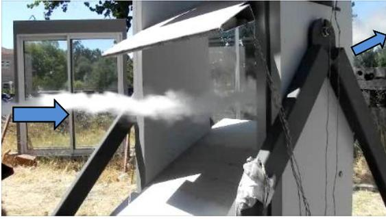
**Fig 11** - Visualização do escoamento com injeção de fumo para  $\alpha=30^\circ$ . As setas assinalam a direção do fumo a montante e a jusante da cascata.
