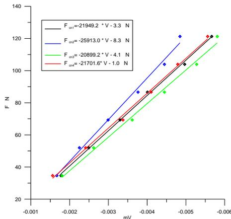
Fig 7 - Curvas de calibração dos defórmetros.
