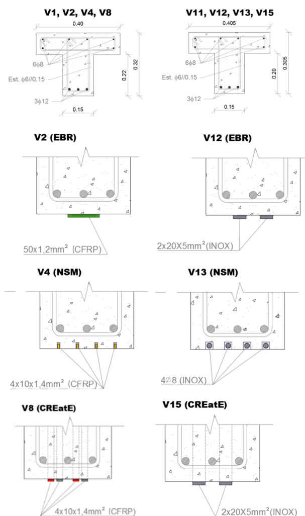
Fig. 3 - Pormenores com o tipo de reforço utilizado nas vigas: V2 e V12 (técnica EBR); V4 e V13 (técnica NSM); V8 e V15 (técnica CREatE) e respetiva seção transversal
