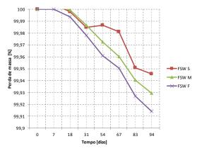
Fig.8 – Perda de massa ocorrida nas amostras do ensaio de corrosão em água do mar.
