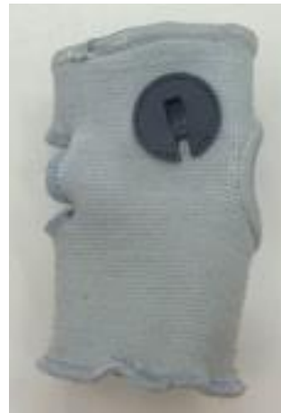
Fig 2. Luva desenvolvida para o posicionamento do acelerómetro.
