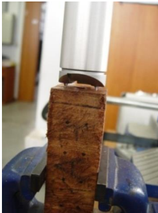
Fig 1- Utilização do equipamento Pilodyn em laboratório.
