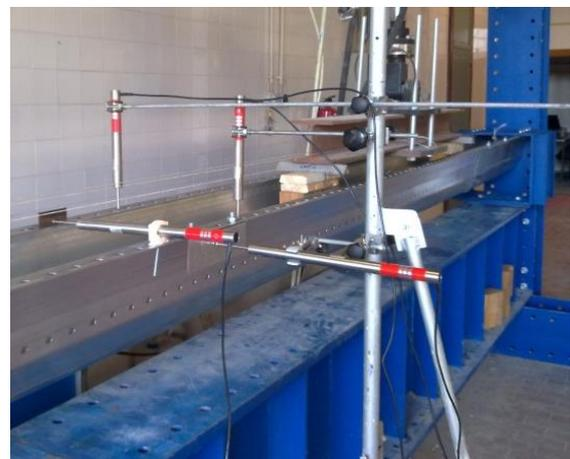
**Fig. 8** – Transdutores de deslocamentos usados no esquema de ensaio C.
