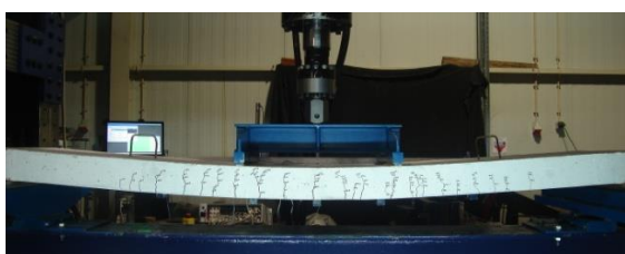
Fig. 4 – Ensaio à flexão sob quatro pontos de carga.
