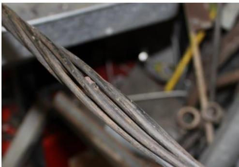
Fig. 10 – Alargamento do cordão e colocação de espaçadores metálicos.
