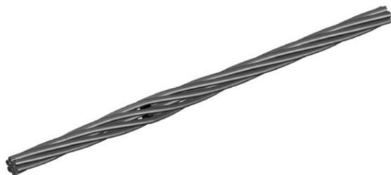
Fig. 7 – Aumento localizado no diâmetro nominal do cordão de aço (PHI).
