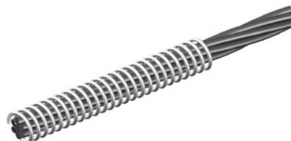
Fig. 5 – Cinta helicoidal de aço como elemento de confinamento (SPR).
