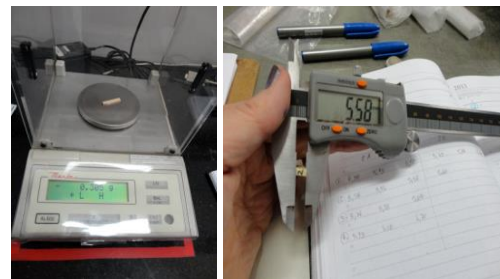
Fig. 2b e 2c – Balança para pesagem e medição das amostras com paquímetro
