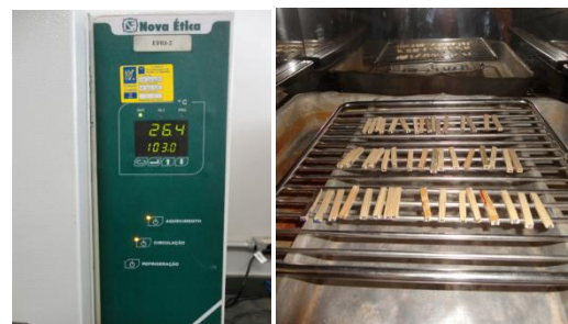
Fig. 3a e 3b – Estufa onde as amostras foram acondicionadas
