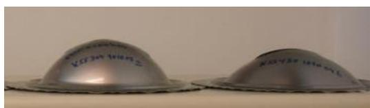
Fig. 13 – Provetes AISI 304 e 430 após rotura.
