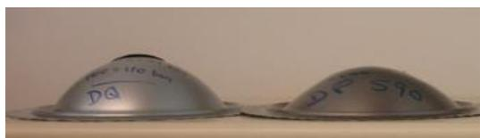
Fig. 12 - Provetes DQ e DP590 após rotura.
