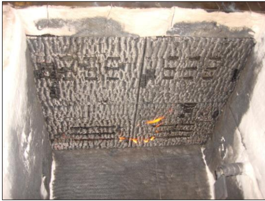
Fig. 9 – Posição da laje 1 no forno de resistência, depois do ensaio.
