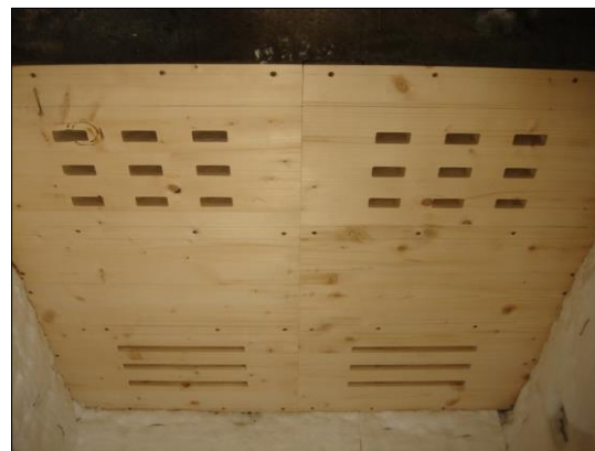
Fig. 8 – Posição da laje 1 no forno de resistência, antes do ensaio.
