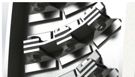
Fig 22 – Detalhe da região de encastramento da sugestão de projecto para um novo estator. Note-se o material intermédio existente entre a pá e os suportes, que pode ser fabricado de materiais específicos para modificar a resposta dinâmica da pá.
