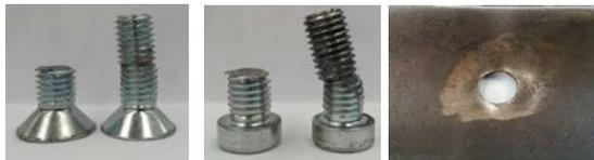
Fig. 11 – Parafusos e chapas após ensaios (M12)
