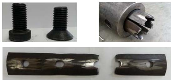
Fig. 12 – Parafusos e chapas após ensaio (M16)
