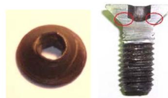
Fig. 7 – Rotura do parafuso
