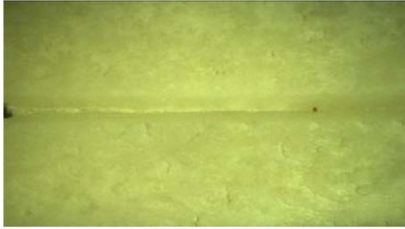
**Fig. 5.** Detalhe da região da extremidade de fenda no ensaio ENF, evidenciando a difícil identificação da sua extremidade.
