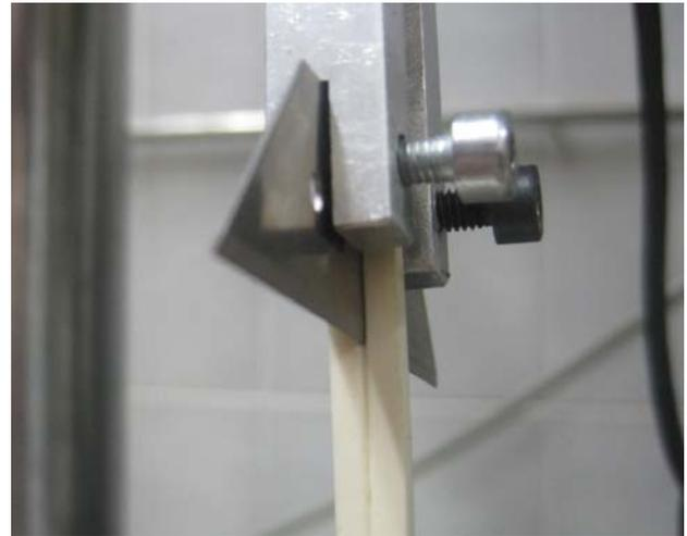
**Fig. 3.** Operação de propagação da fenda inicial com uma lâmina de X-ato.
