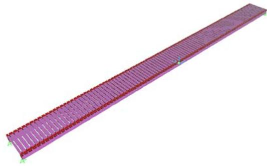
**Fig. 6** – Modelo numérico reduzido de passarela de madeira.
