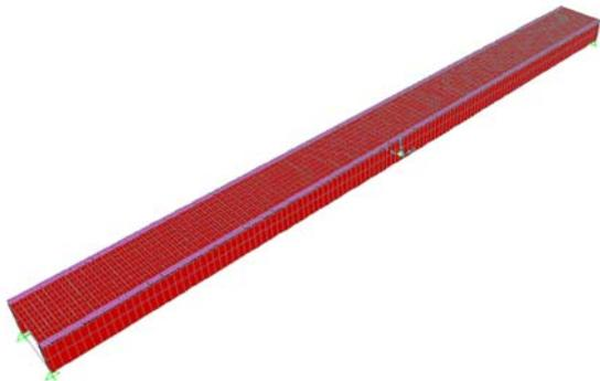
**Fig. 5** – Modelo numérico de passarela de madeira.
