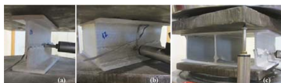
Fig. 4 – Ensaios de compressão transversal das almas: (a) 1 alma, (b) 2 almas com PU e (c) 3 almas.
