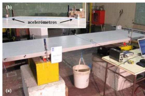
Fig. 11 – Esquema dos ensaios dinâmicos: (a) vista geral e (b) posicionamento dos acelerómetros.
