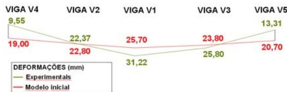
**Fig. 14** – Comparação das deformações numéricas e experimentais a meio vão das 5 vigas centrais obtidas no ensaio E1.
