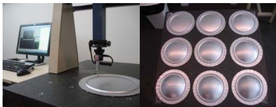
Fig. 14 – Medição 3D dos provetes obtidos para diferentes pressões de “bulge”.
