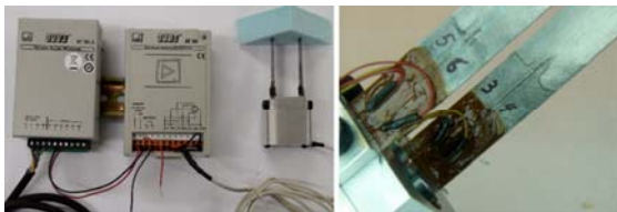
Fig. 4 – (a) Fonte de alimentação, amplificador e dispositivo desenvolvido de medição de deformações (b) pormenor da colocação dos extensómetros nas lâminas de deformação.
