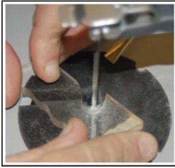
Fig 8 – Recorte do contorno externo da infraestrutura protética numa placa fotoelástica de 6,5mm.
