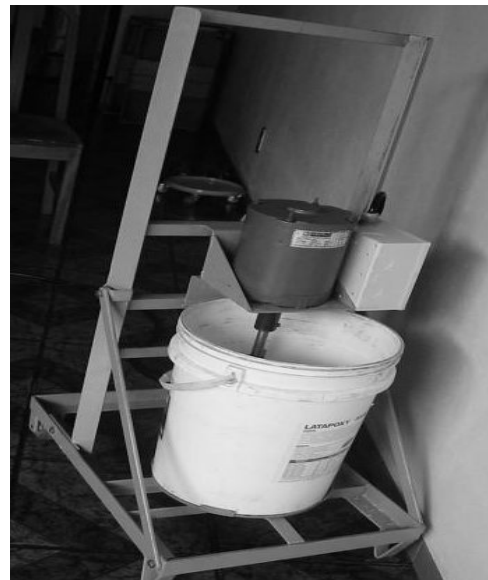
Fig 1: Batedor de Argamassa
