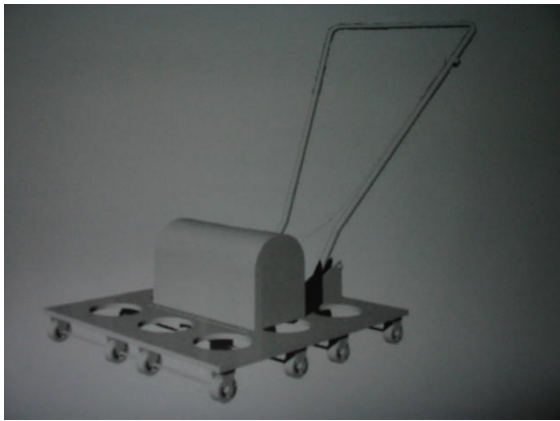
Fig 3: Equipamento Vibrador sobre as cerâmicas
