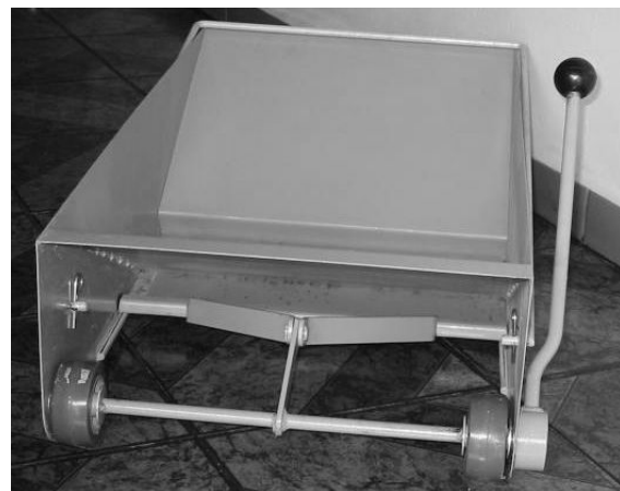
Fig 2: Aplicador contínuo de argamassa
