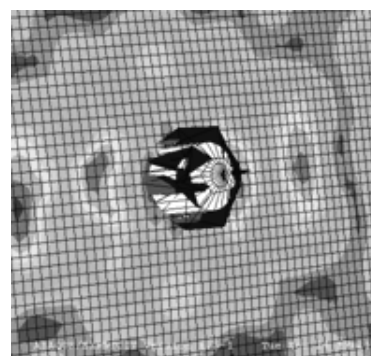
Fig 6 – Fase final da simulação, a ponta da broca já é visível do lado oposto da placa.
